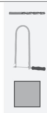
Bohre die Löcher  $\varnothing 3$  mm in Teil (B) und ebenso in die beiden Kreisausschnitte, damit du die **Laubsäge einfädeln** kannst. Säge die Ausschnitte aus und arbeite **alle Kanten und Flächen** mit Schleifpapier nach.
