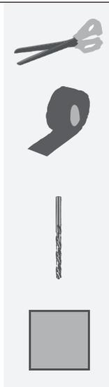
Schneide die Schablonen für die Teile (C und D) grob mit der Schere aus und klebe sie mit transparentem Klebeband auf die Zirbenholzleisten. Bohre die Löcher  $\text{Ø } 3 \text{ bzw. } \text{Ø } 6,5 \text{ mm}$ . Arbeite die beide Teile mit Schleifpapier nach.
