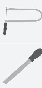
Schneide nun alle Teile mit einer Laubsäge bzw. Feinsäge aus. Versuche beim Sägen entlang der Schnittkanten die **Laubsäge möglichst senkrecht** zu halten. Arbeite die Schnittkanten mit Schmirgelpapier oder mit einer Holzfeile nach. Die obere Kante von Grundbrett (O) gut **abgerunden** oder mit einer Feile eine **Fase** (Schräge) anbringen.
