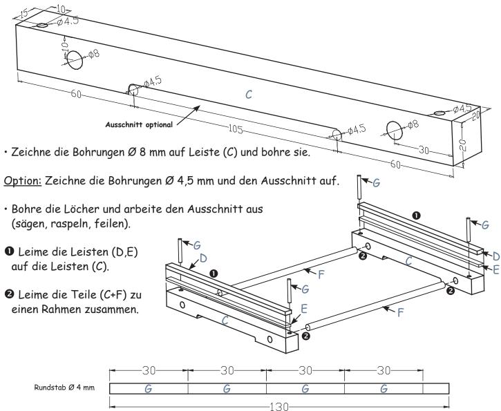
· Säge die Rundstäbe (G) nach Abbildung ab und stecke sie in die Bohrungen der Teile (C).
